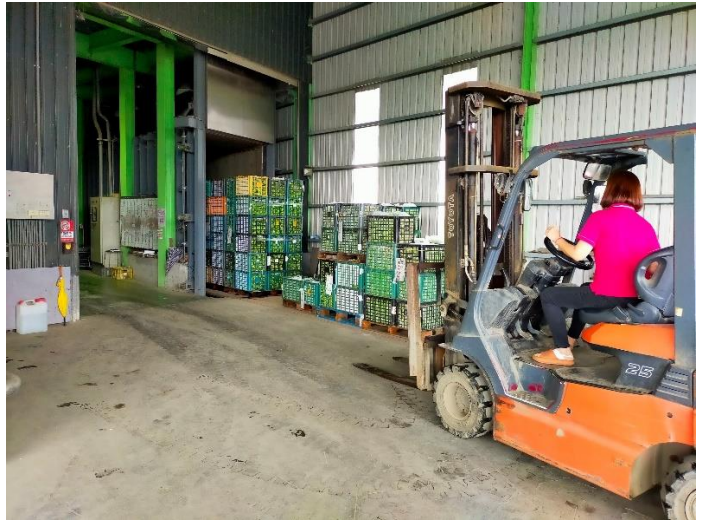
真空預冷作業中
